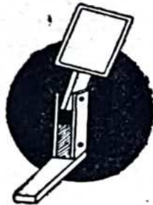
A montagem dos braços dos espelhos.
